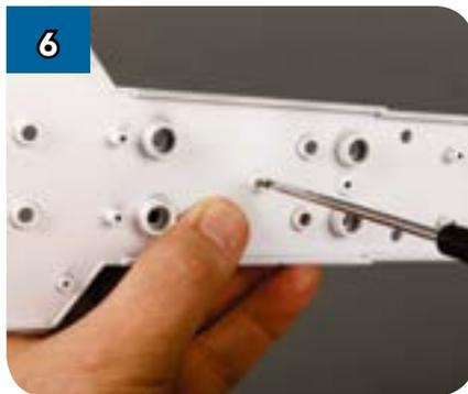
Проверните конструкцию и заверните серебристый винт 2 x 6 мм в первое отверстие...
