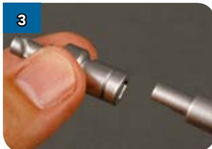
Смажьте D-образный конец детали (LPR-06) быстросохнущим клеем и вставьте его в соответствующее отверстие в детали (LPR-05).
