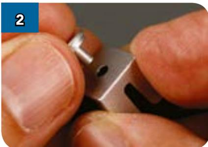
Смажьте штифт детали (LPR-04) небольшим количеством быстросохнущего клея и вставьте его в отверстие в детали (LPR-03).
