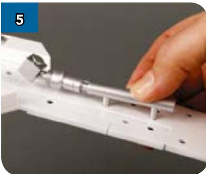
Вставьте установочные штифты детали (LPR-06) в соответствующие отверстия в детали (LPL-02).
